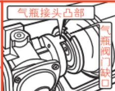
**⚠ 警告** 如左图所示,请将迷你气瓶的阀门缺口(凹部)对准岩谷便携气具Junior产品系列的气瓶接头凸部安装。
